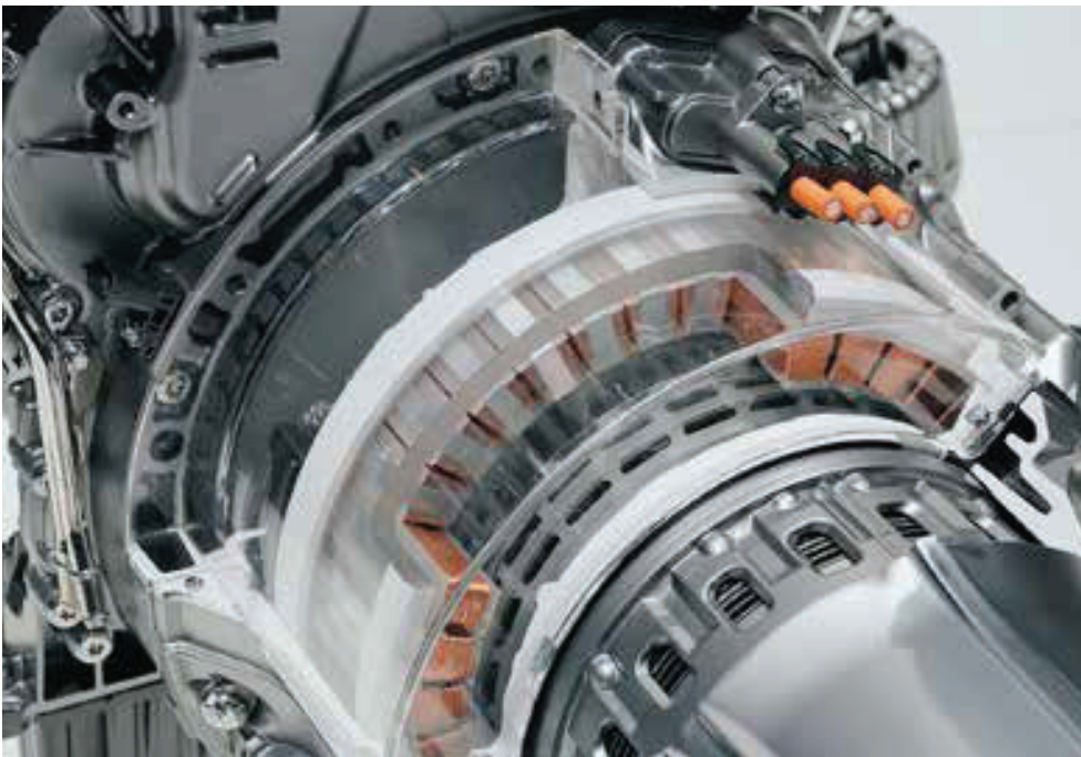
4.1 Asennettuna pituussuunnassa tai poikittain: Klassisissa rinnakkaishybrideissä sähkömoottori sijaitsee tyypillisesti polttomoottorin ja voimansiirron välissä.
