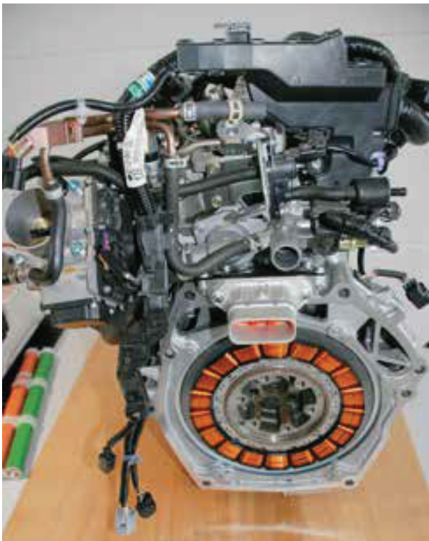
4.6 Suoraan laipassa: Honda IMA -hybridijärjestelmässä sähkömoottori on kiinnitetty suoraan polttomoottorin kampiakseliin eikä välissä ole kytkintä.
