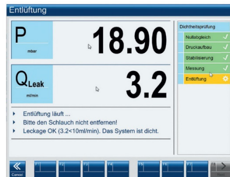
8.3 Mustaa valkoisella: testeri näyttää, läpäistiinkö vuototesti vai ei. Kuva: AVL Ditest
