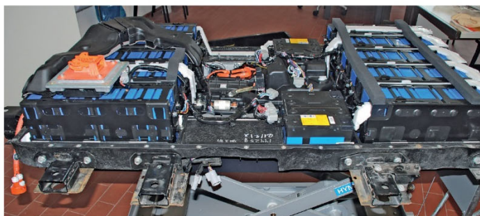
8.1 a+b Testauksen periaatekuva: vuototestilaitteesta ali- tai ylipaineen muodostamiseen tarvittava letku on asennettava akkukotelon sopivaan liitäntään (esim. HV-liitäntään) erityisillä sovitimilla. Kuvat: AVL Ditest, Hyundai
