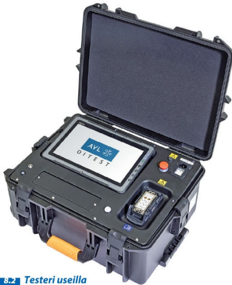
8.2 Testeri useilla toiminnoilla: korkeajänniteakun vuototestin lisäksi HV-satelliitin avulla on mahdollista tehdä myös muita HV-järjestelmän testejä. Kuva: AVL Ditest
