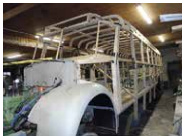
Vanhassa koritehtaassa tehdään nyt uutta koria Sisun vm. 1949 alustalle.
