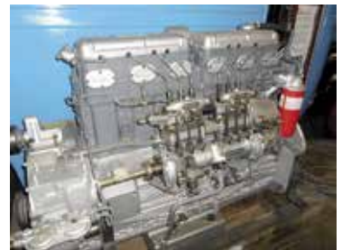
Gardner-moottori, joita asennettiin Kabus-autoihin v. 1985-1989. Saavutettiin jopa 4 milj. km ajomääriä. Kuvan moottori on ajamaton peruskorjattu.
