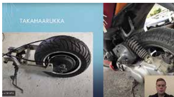
Tässä Teponojan kuvia skootterimopon sähköisen voimaketin toteutuksesta.
