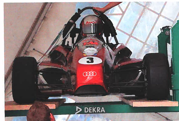
Yhtenä katsastustarkastuksena on kallistustesti, jossa auto kallistetaan kulmaan, joka vastaa lähes 1 g:n sivuttaiskiihtyvyyttä. Auto ei tällöin saa kaatua eikä vuotaa nesteitä.
