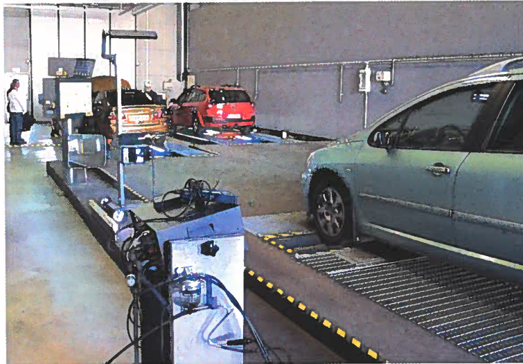
Riihimäen Katsastuslinjan tiloissa saatiin mitattua jarrut sekä päästöt bensa-autosta. Lisäksi nostimilla saatiin tarkistettua ruostesuojauksen tila sekä akkujen kunto ja jarrunesteen vesipitoisuus.
