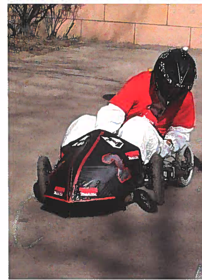
Kisan voittaneen 20n1-09 –tiimin auto oli äärimmilleen kevennetty. Tämä näkyi myös sisämutkan eturenkaan nousemisena ilman radan tiukassa mutkassa.
