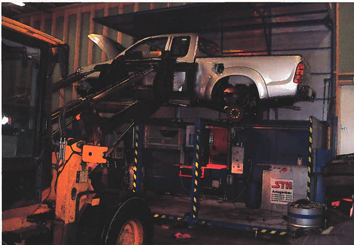
"Kuivaukseen" nostettu, suhteellisen käyttämättömän näköinen auto Stena Metalli Oy:n Kartanon toimipisteessä.
