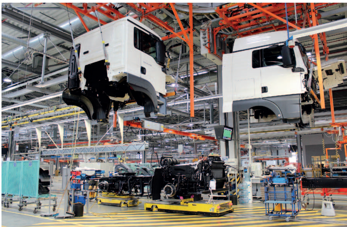
MAN:n kuorma-autotehtaan naittopiste eli paikka, jossa kuorma-auton alusta ja kori kohtaavat.
