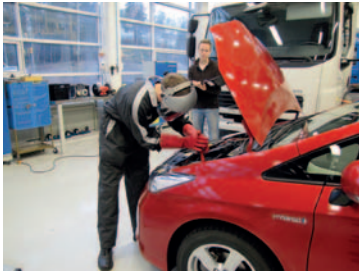
Semifinaalin hybridiauton korkeajänniteakun virrattomaksi tekorasti. Oikeaoppisesti suojautuneena työtä suorittaa Tuomo Pyhäläauto ja työsuoritusta on arvioimassa Tuomo Saikkonen
