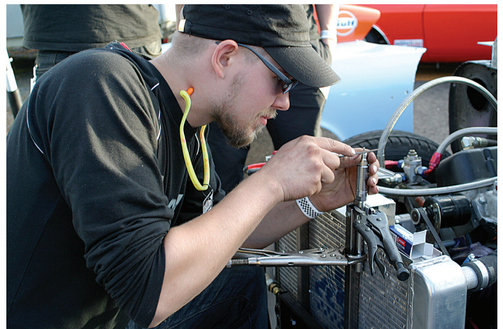
Tommi hienosäätämässä sytytustulppia. Ruuvipenkin virkaa ajaa jäähtytimen kiinnitysrunko. Hetkeä myöhemmin kierrettiin varikkoa kyselemässä jäähtyttäjän paikkausainetta lainaksi, tilanteesta selvittiin kuitenkin kunnialla.
